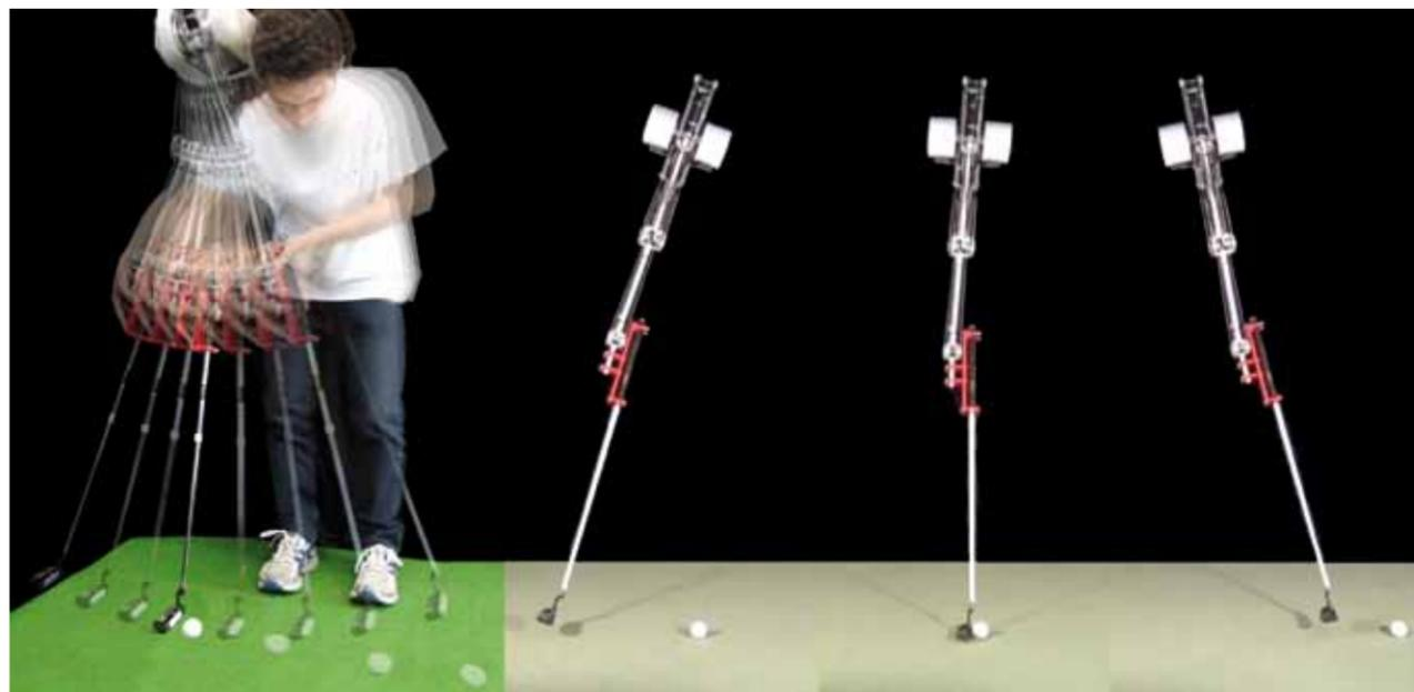
Abb. 1: Das BioRob-System kann Putt-Bewegungen autonom (rechts) oder interaktiv (links) ausführen.
