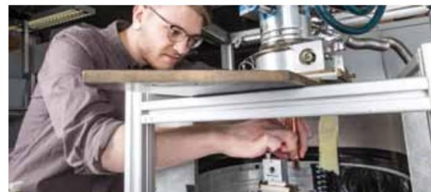
Abb. 2: Einzigartiger Versuchsaufbau zur Röntgenbeugung im Magnetfeld.
