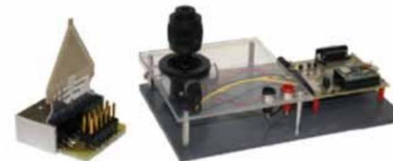
Abb. 2: Mechanische Aufnahme mit einer Mikropositionierplattform aus PEEK und Funktionsmuster der Steuerelektronik.
